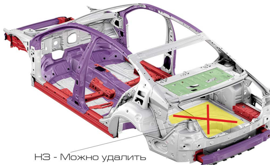
Рис. 4. Общая схема силовой структуры кузова.
