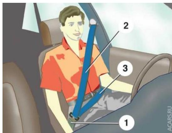
Рис. 5.5. Фиксация ремней безопасности.
