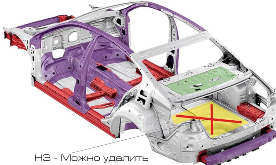
Рис. 8.4. Общая схема силовой структуры кузова.
