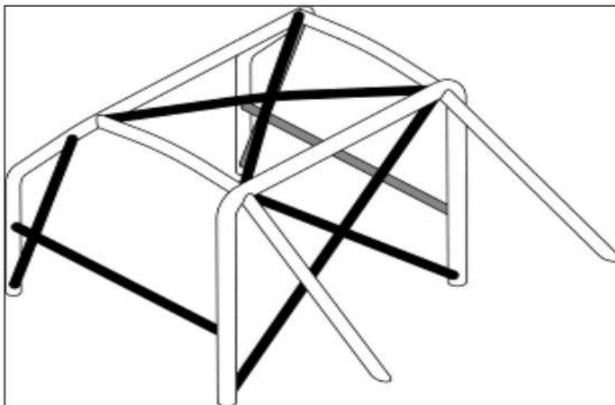
Рис. 8.2. Минимальная схема каркаса безопасности.
