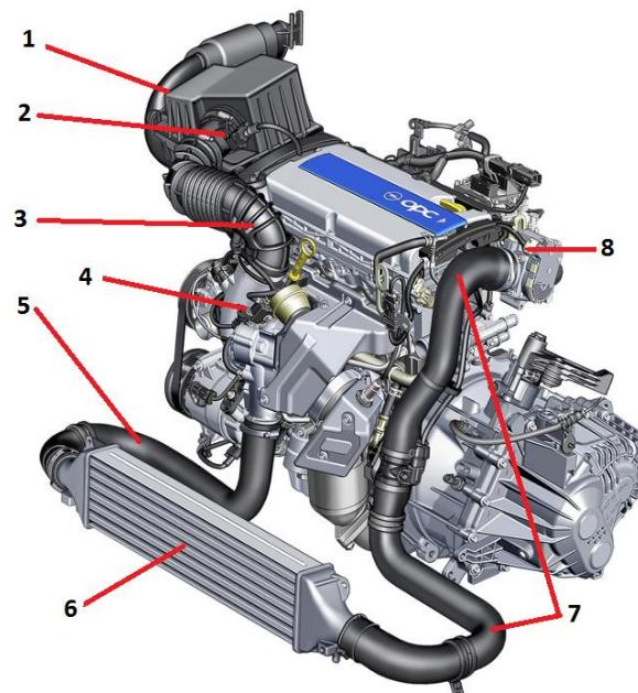
Рис. 8.4. Элементы системы впуска двигателя с турбонаддувом:
